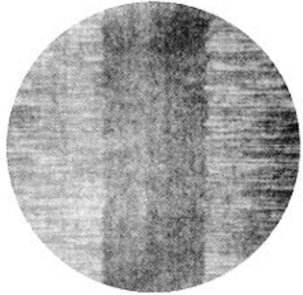
图6 磨斑内部损伤 10X
